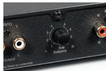
Wyjątkowym układem jest również mikroregulacja zrównoważenia kanałów, dzięki której skompensujemy niedokładności wykonania wkładek.
