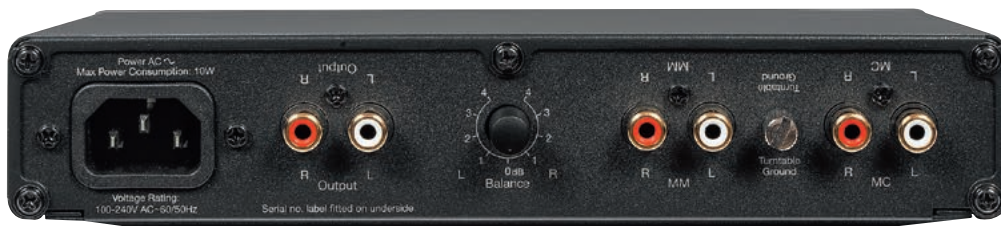
Dla obydwu typów wkładek przygotowano niezależne wejścia, gniazdo wyjściowe jest już pojedyncze i nie działa tutaj regulacja głośności.
